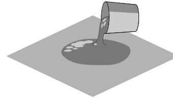
auf die tieferen Bereiche aufbringen, so dass sich eine gleichmäßige Grundlage ergibt. Sobald diese erste Schicht begehbar ist (nach ca. 3 Stunden bei 23 °C) mit 60 - 80 g/m<sup>2</sup> Tile Primer behandeln und abwarten, bis die Grundierung vollständig trocken ist (d.h. bis sich ein transparenter Film gebildet hat). Dann eine zweite, max. 30 mm dicke Schicht Livellina 5-30 auftragen. Die Arbeitsgeräte können vor dem Aushärten mit Wasser, anschließend nur mechanisch gereinigt werden.
