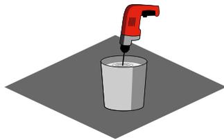
Pour les sous-couches absorbantes, avant d'appliquer Multifinish, mouiller le support jusqu'à saturation et laisser l'excès d'eau s'évaporer ou le retirer avec une éponge. Les supports constitués de vieilles peintures, d'enduits/revêtements en plastique, de vieux revêtements en mosaïque de céramique et de verre, doivent être parfaitement secs.
