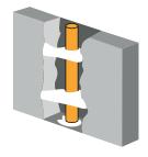
Posa e bloccaggio condotti idraulici/elettrici
