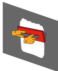
darf die Fuge nicht verstopft werden. In diesen Fällen wird empfohlen ein Band aus Polystyrol und/oder Polyurethan einzufügen. Nach Aushärtung der letzten Schicht Flex 1K das Klebeband wieder entfernen. Die Fuge gründlich von Staub und Material reinigen und mit dem Silikon-Dichtstoff Low Modulus abdichten.
