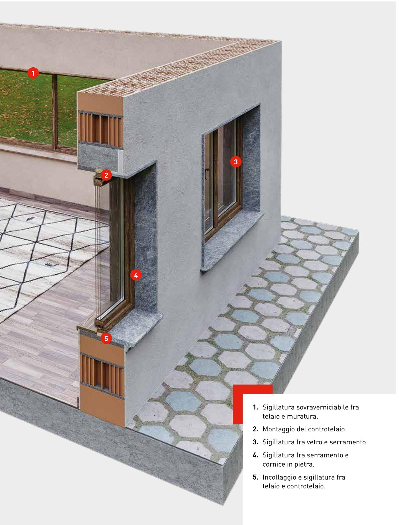
1. Sigillatura sovraverniciabile fra telaio e muratura.
